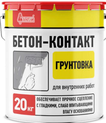
Предназначена для предварительной обработки плотных, гладких, слабо впитывающих влагу оснований (монолитный бетон, бетонные блоки, плиты и т.п.) внутри помещений перед нанесением гипсовых штукатурок. Применяется для грунтования поверхностей, покрытых плиткой или масляной краской, перед штукатурными или облицовочными работами. Не предназначена для последующего нанесения цементных штукатурок и для грунтования поверхностей пола.
