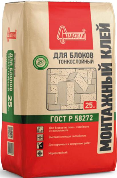
Предназначен для кладки стен в малоэтажном строительстве, возведения перегородок и ограждений из пазовых и беспазовых блоков и плит на основе ячеистого бетона, газосиликата, легких заполнителей. Тонкослойная кладка предотвращает появление термических мостиков и гарантирует одинаковые параметры тепловой изоляции всей конструкции. Допускается использование материала для шпатлевания поверхности блоков слоем от 2 до 5 мм. Применяется для наружных и внутренних работ.
