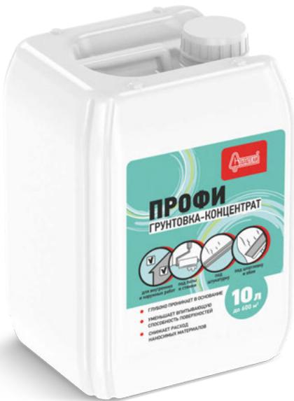
Концентрированный состав, предназначенный для профессионального применения. Разбавляется водой в соотношении от 1:1 до 1:5 в зависимости от впитывающей способности поверхности и типа проводимых отделочных работ. Предназначена для укрепления старых, рыхлых, отмеливающих оснований, обеспечивает равномерное схватывание раствора гипсовых и цементных смесей, увеличивает прочность сцепления наносимых материалов с основанием. Подходит для наружных и внутренних работ.
